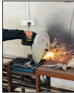
Rajah 3.6: Proses memotong besi untuk dibuat kaki meja mesin muruku
