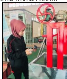
Rajah 3. 8: Proses semburan cat pada bingkai hadapan mesin muruku
