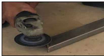
Rajah 3. 7: Proses mencanai besi bingkai hadapan mesin muruku
